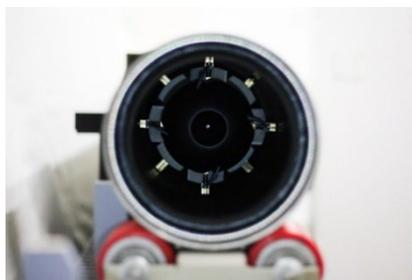
Рис. 2. Конструкция восьмиканального модуля измерительных преобразователей
