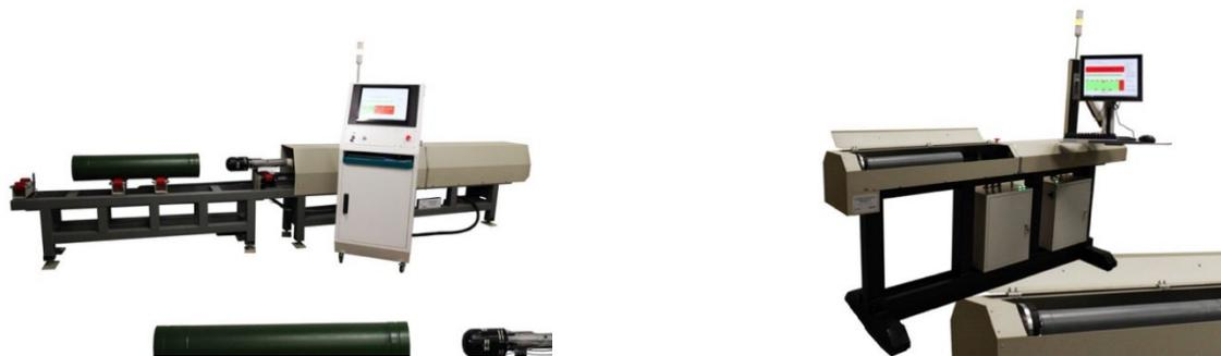
Рис. 1. Внешний вид многоканальных автоматизированных систем контроля толщины теплозащитных покрытий на внутренней поверхности цилиндрических изделий для двух исполнений
