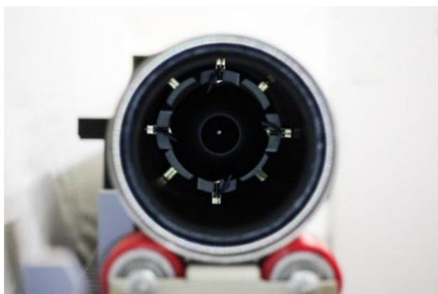
Рис. 2. Конструкция восьмиканального модуля измерительных преобразователей
