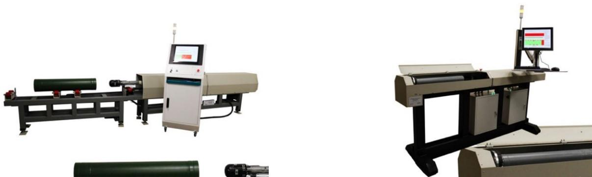
Рис. 1. Внешний вид многоканальных автоматизированных систем контроля толщины теплозащитных покрытий на внутренней поверхности цилиндрических изделий для двух исполнений
