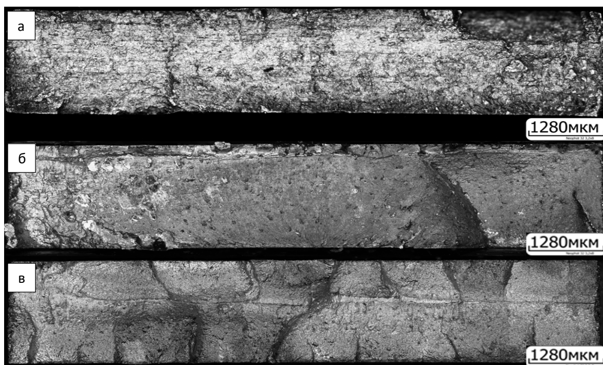
Рис. 1. Оптические изображения изломов образца № 1 (а), образца № 2 (б) и образца № 3 (в), разрушенных от усталости.
